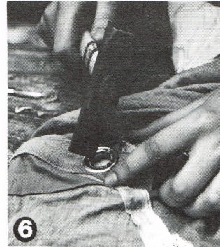
6. Rabattre doucement au marteau les bords de l'œillet pour fixer ensemble ses deux parties.
