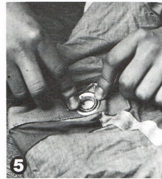
5. Poser l'œillet, une partie à l'extérieur, une partie à l'intérieur, emboîtant cuir et toile.
